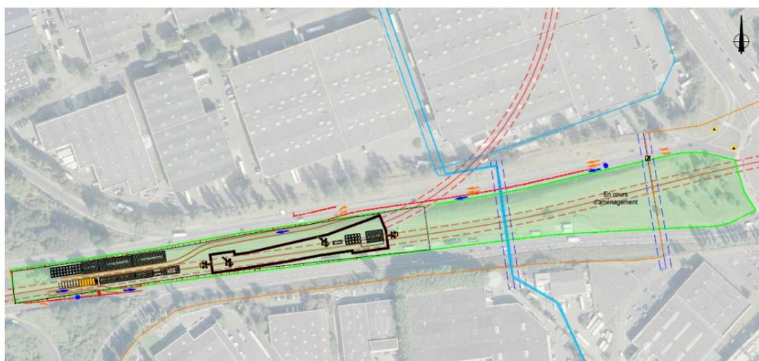
Site de l'ouvrage 0202P : phase de réalisation des parois moulées, seule la partie ouest de l'emprise est occupée
