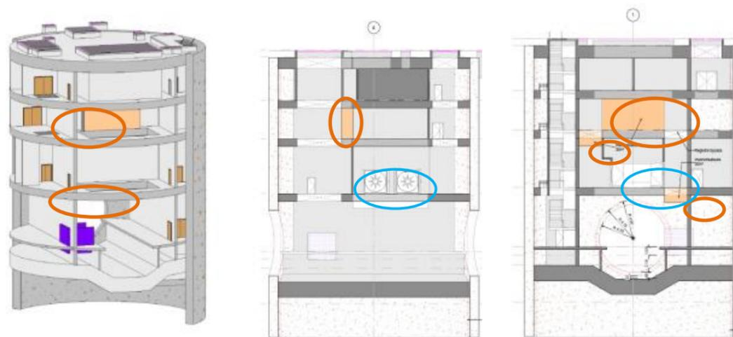
Localisation des pièges à son (en orange) dans les puits – exemple du puits OA0401P
